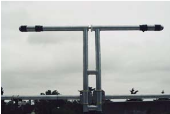
Dipolo en proceso de medición
