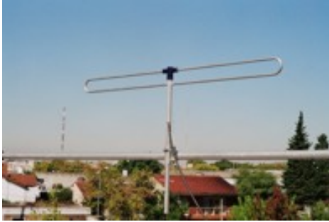
Dipolo en proceso de medición
